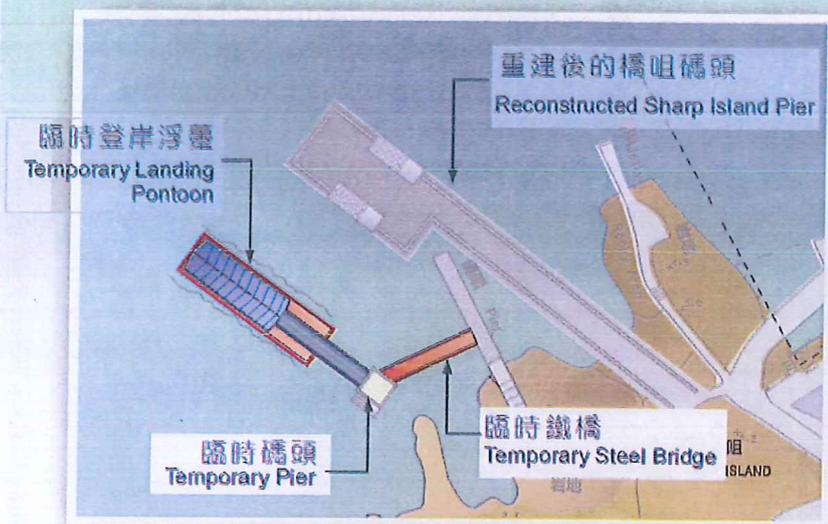
臨時登岸設施的組成：包括一個鋼鐵結構之臨時碼頭，由一條臨時鐵橋連接現時橋咀島碼頭，而一艘臨時登岸浮臺停泊於臨時碼頭，供船隻靠泊，及給乘客登岸和登船。
