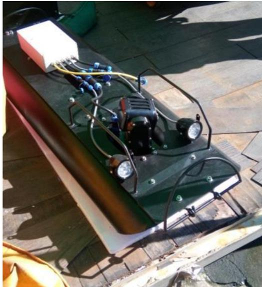
浮船載具聲納系統和閉路電視儀器
