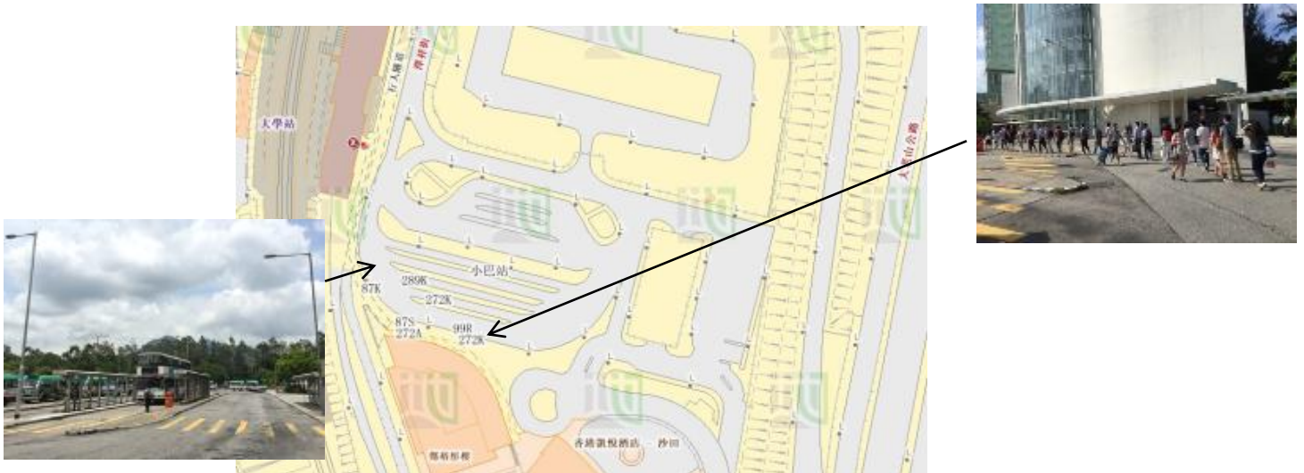
◆ 圖 5.12 坑狀露天車站設計，地圖顯示各路線車站分置在不同坑道（地政總署提供地理資訊地圖）
