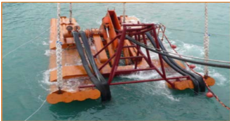
雪橇式掩埋器 Sledge Burial Tool
