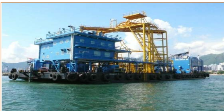
光纜鋪設躉船 Cable Barge
