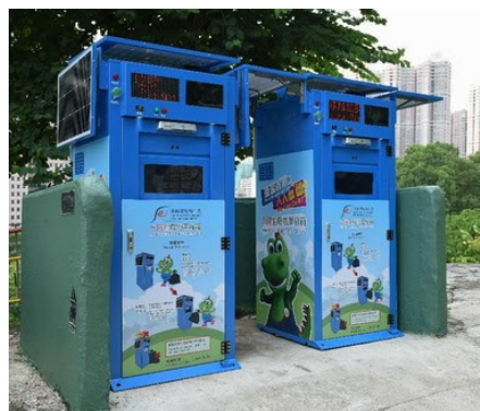
圖三：第三代太陽能廢物壓縮箱收集家居廢物
