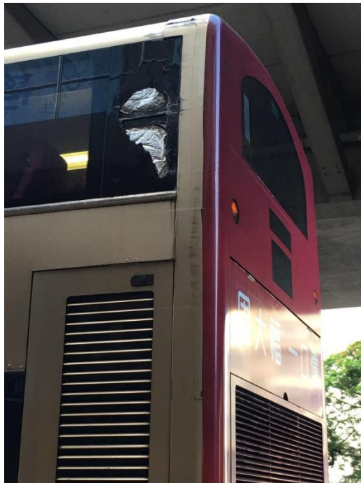
撞上樁樑後巴士車身損壞
