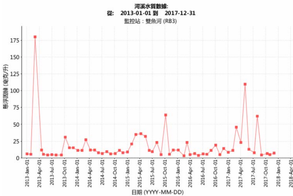
圖 8 雙魚河 2013 年至 2017 年間在近石上河一段的抽樣檢定河溪水質數據（河水懸浮固體數目）
