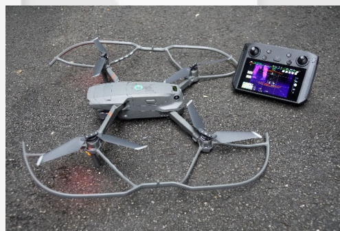
航拍機進行外牆渠管檢測
