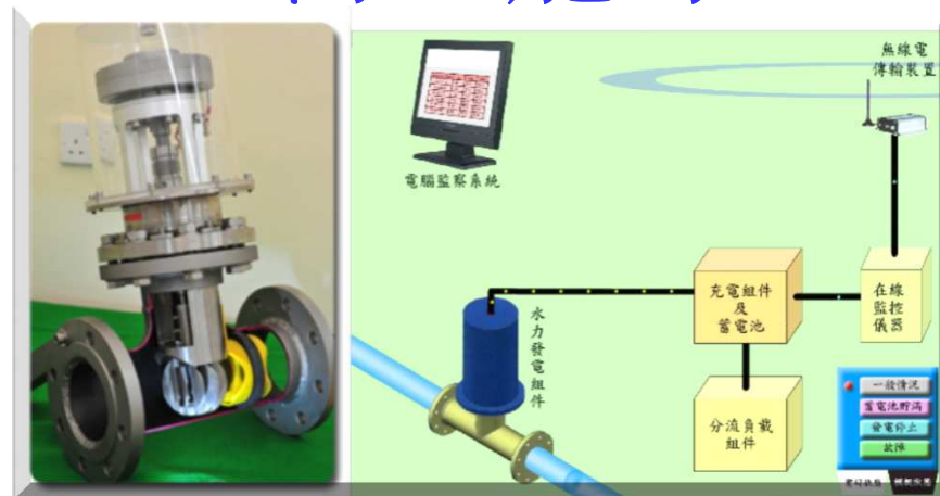
內聯閉式水力發電裝置
