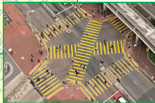
沙角街/逸泰街交界 增設對角行人過路處
