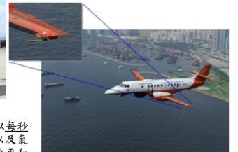
先進的專屬氣象數據量度系統，以每秒20次的高頻率量度飛行位置，以及氣象數據包括氣壓、溫度、濕度、水平和垂直的風速與風向。
