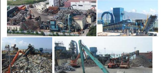
把廢鐵類金屬分類及切碎，然後運往東南亞，再造成如鋼筋等的建築材料。已於2016年5月投產。
