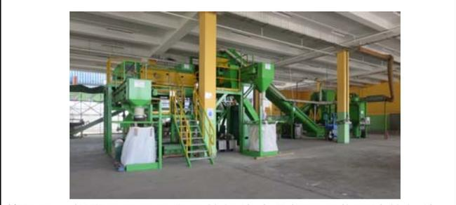
修理及分拆廢電器電子產品的組件成各類可回收再造的組件。現正進行機器測試，預計於2017年第三季投產。
