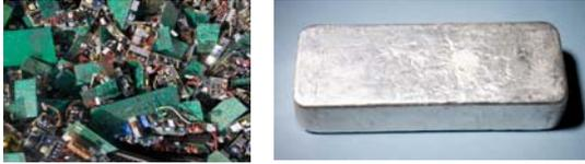
分拆印刷電路板中的玻璃纖維及各類金屬，並提煉各種貴金屬致可供有關行業直接使用的純度，包括金、銀、銅及鈦。租約於2017年1月開始生效。
