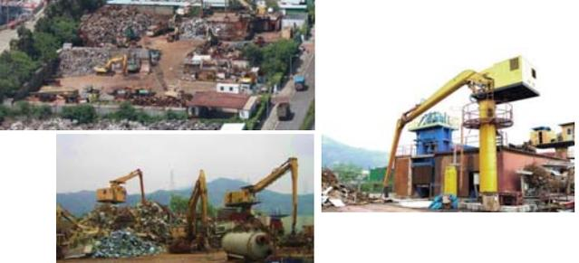
把廢鐵類金屬分類及切碎，然後運往東南亞，再造成如鋼筋等的建築材料。
