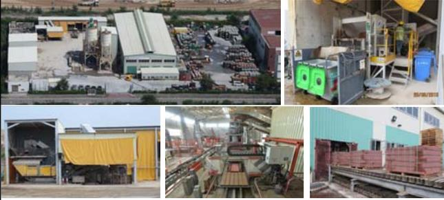
回收建築廢料/廢玻璃，透過打碎、混漿、倒模、脫水過程，再造成環保磚。已於2014年11月投產。
