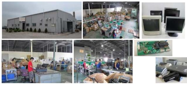
修理及分拆廢電腦組件成各類可回收再造的組件。
