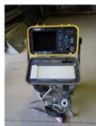
閉路電視操作及顯示器
