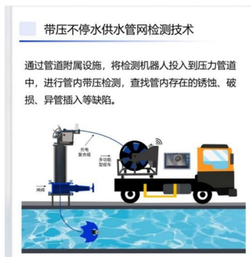
附圖二：帶壓不停水管網檢測技術
