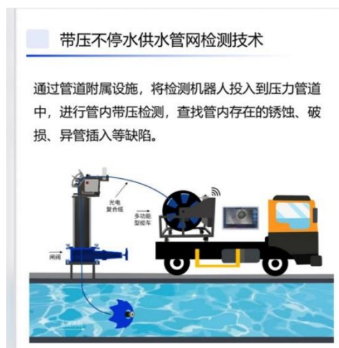
附圖二：帶壓不停水管網檢測技術
