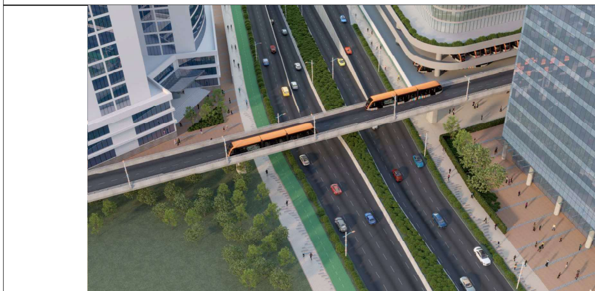
在主要及繁忙路口的交界處與其他路面交通分隔的高架段
