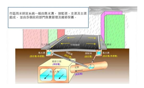
3. 渠務署檢視早前水浸事件情況及區內雨水排放系統的表現,留意到 2023 年 9 月 7 至 8 日的極端降雨超越公共排水系統的排洪能力,暴雨期間大量沙泥、樹葉、樹枝和雜物隨雨水徑流沖至路面集水溝並造成阻塞,均是導致水浸事故的成因。
